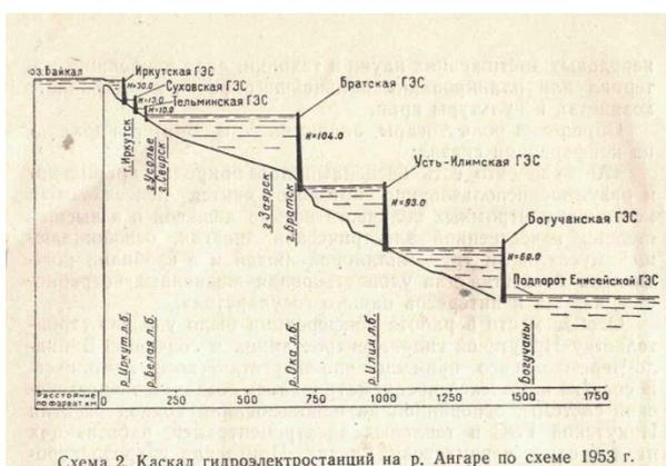
В 1953 году Гидроэнергопроект составил схему, по которой на р. Ангаре – «реке электричества», предусматривалось строительство каскада гидроэлектростанций. Братская ГЭС являлась самой мощной ступенью этого каскада. Был
