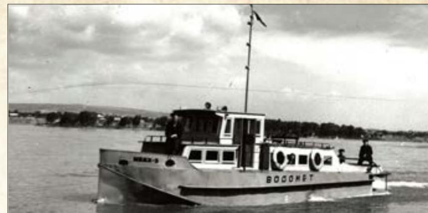
Буксирный катер МВКХ-5 с водометным движителем мощностью 90 л.с., освоен серийным производством в 1952 г., построено 212 единиц. КГКУ «ГАКК». Ф.П-7835. Оп.8. Д.126. Л.18
