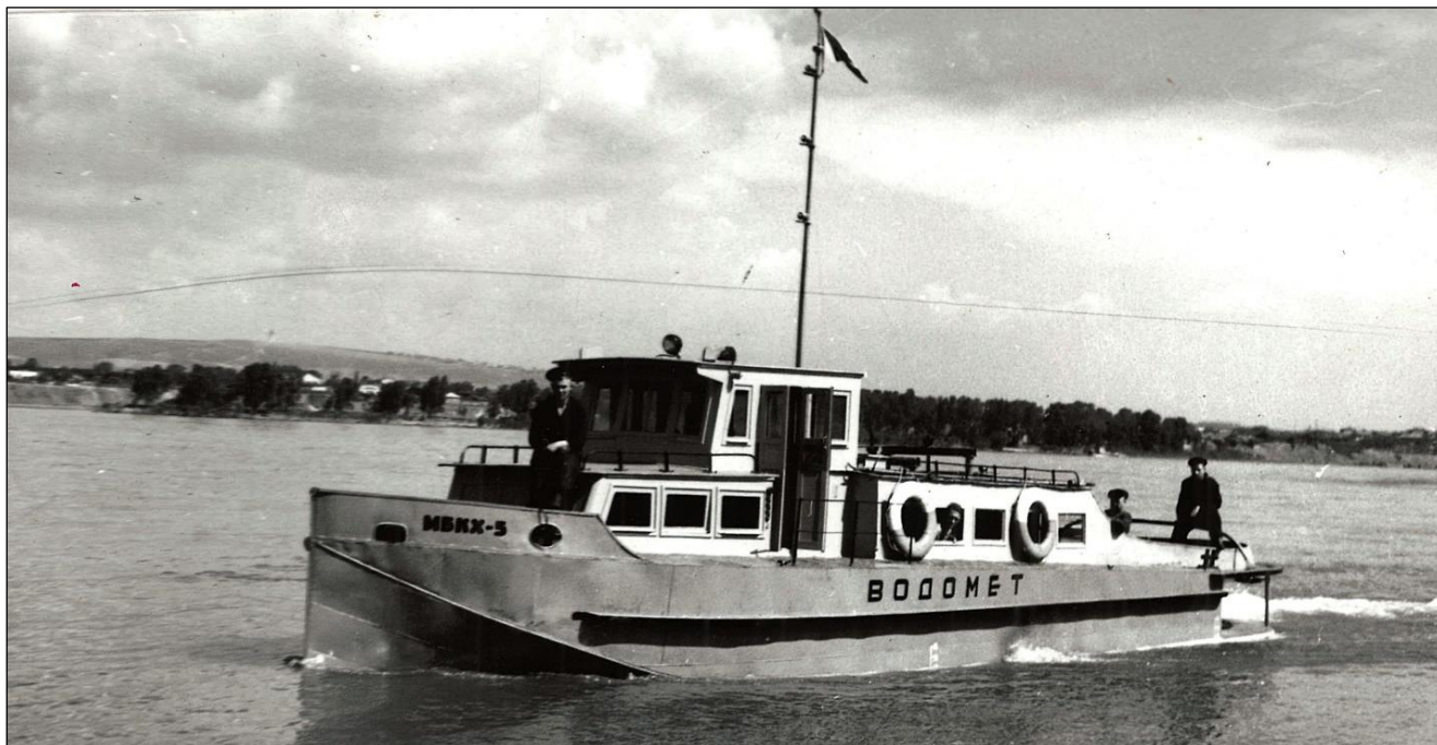
Буксирный катер МБКХ-5 с водометным двигателем мощностью 90 л.с., освоен серийным производством в 1952 г., построено 212 единиц. КГКУ «ГАКК». Ф.П-7835. Оп.8. Д.126. Л.18
